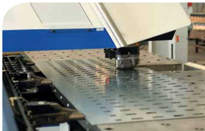
TopSolid'Sheetmetal propose des stratégies d'usinage pour chaque outil afin d'optimiser le parcours de la tête de poinçonnage sur la tôle
