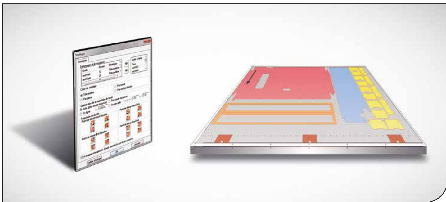
TopSolid'Sheetmetal propose des stratégies d'usinage pour chaque outil afin d'optimiser le parcours de la tête de poinçonnage sur la tôle
