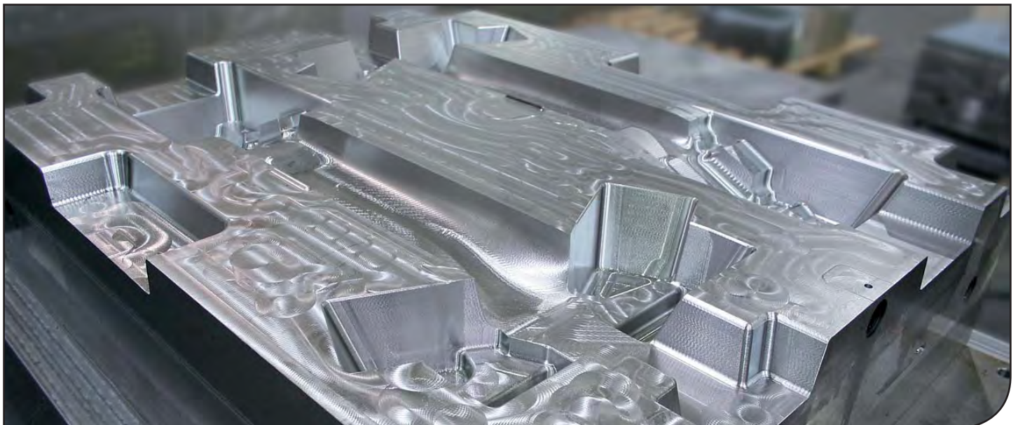
Les cycles de superfinition permettent d'obtenir des états de surface particulièrement soignés. (Société Aalbers, Amérique du Nord)
